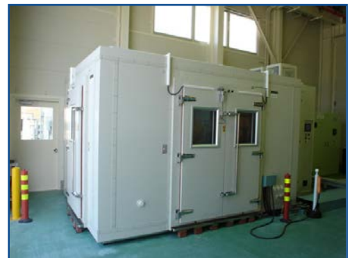
大型恒温槽 （大型容器にも対応可能）
