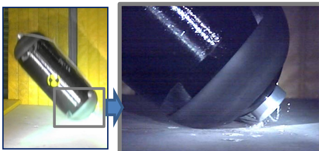
容器落下試験（高速度カメラによる落下箇所撮影）
